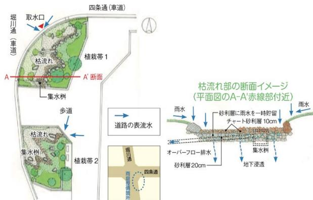
四条堀川交差点雨庭の平面図と断面図
