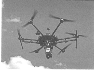
レーザースカナー搭載ドローン
