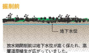
放水路掘削前は地下水位が高く保たれ、高層湿原植生が広がっていました。
