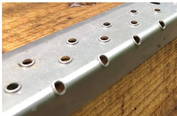
写真-2: すべり止め板の穴加工
