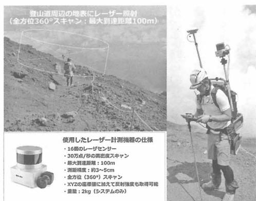
図1 レーザー計測機器
