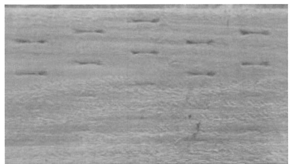
図5 注入処理後のインサイジング穴の外観 (上段: 試作初期刃、下段: 試作最終刃)
